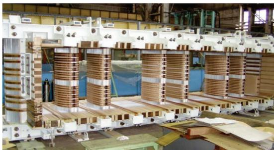
Рис. 1. Магнитная система трехфазного УШР с подмагничиванием[1]
