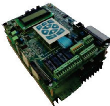
Рис. 2. Преобразователь частоты FC-01
